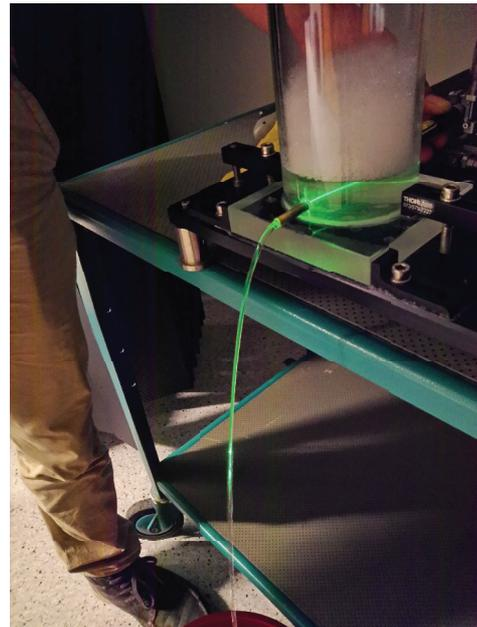
Das Licht des Lasers wird durch den Wasserstrahl (Lichtleiter) um die Kurve gelenkt.
