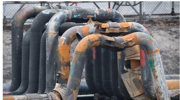
Figur 5: Foto der zerborsteten und zerstörten Rohrleitungen in der Umgebung der Unfallstelle
