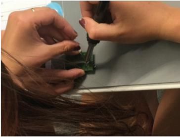
Das Löten ist ein Verfahren wo man 2 Metallstücke mit flüssigem Metall miteinander verbindet. Das Metall ist normalerweise ein Lötzinn.
